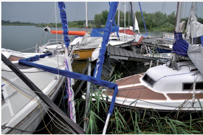
Das eigentliche Ausmaß der Zerstörung konnten die Mitglieder erst nach Beendigung des Sturms überblicken: Sie hatten 31 Boote an den beiden Steg-Anlagen im Wasser liegen; ein Steg wurde mit den daran befestigten Booten etwa 6-8 Meter auf das Land verschoben, der 2. Steg wurde geknickt und mit den Booten an das Ufer gedrückt.
